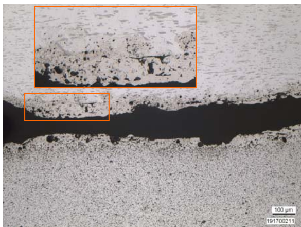
Bild 9 Schliffbild AgNi10 (oben) vs. Ag/SnO 2 88/12 SPW7 (unten) nach Einschaltbelastung
